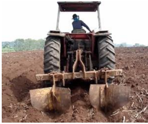
Gambar 14. Proses Pembuatan Kairan dengan menggunakan Furrower
